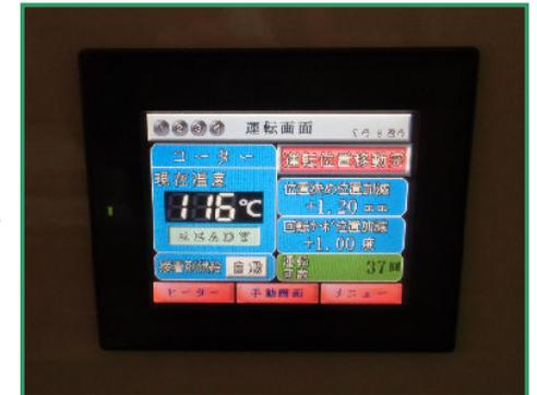
ヒーターの温度管理、ロールコーターの釜の温度などがすべてこのタッチパネルで設定できます。
