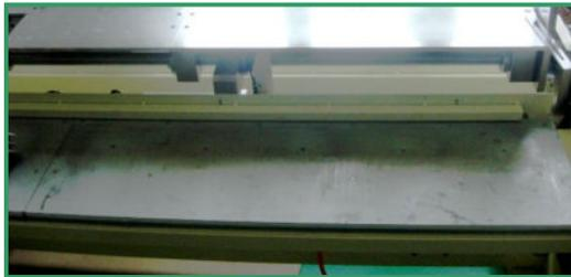
手前にあるパネルにサイディング材短尺6本分(左右)を乗せて加温します。一度に短尺6本分・3セットの加温、または長尺1本分・3セットの加温が可能です。
